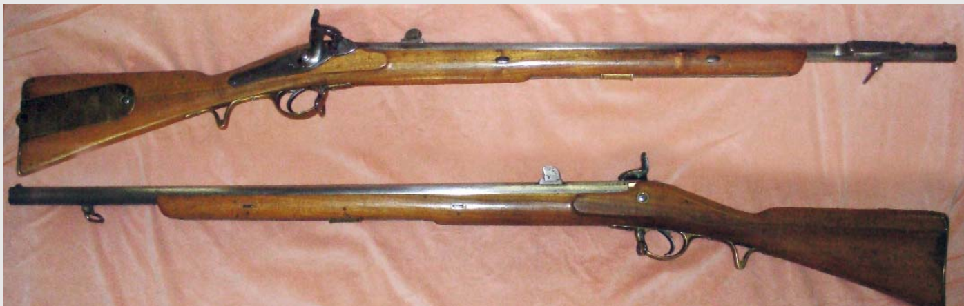
Литвихский штуцер производства Фалиса и Трапмана, 1856 г. (на стволе стоит клеймо производителя). Ствол с 4 нарезами для использования пули Минье
