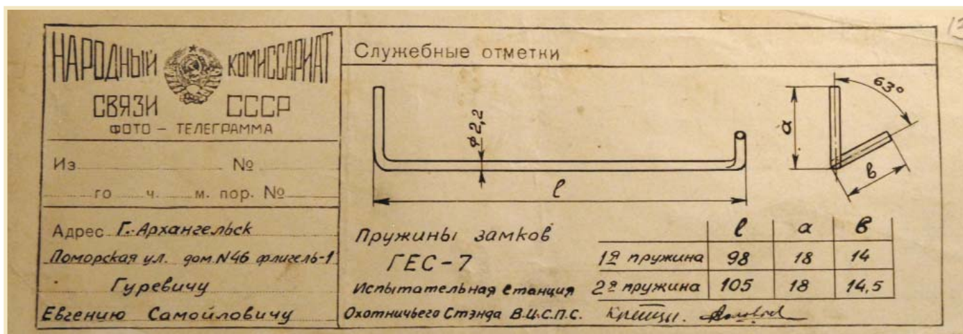
«Крутильная» боевая пружина ружья ГЕС-7
